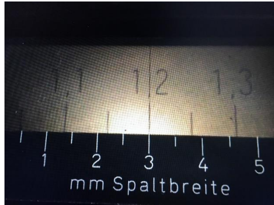
Rys. 3. Przykładowy odczyt wyniku ze skali monochromatora
